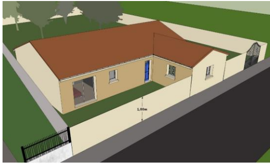
Illustration d'un mur d'une hauteur de 1,8 mètre
