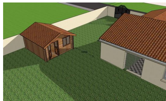
Illustration pour la construction d'un autre bâtiment avec une marge de recul d'au moins 3 mètres
