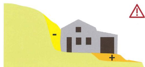
Cette configuration peut provoquer un risque de glissement de terrain, elle crée une cicatrice dans le couvert végétal et dans le paysage.
