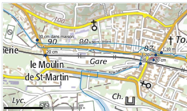
Figure 24 : Hauteurs d'eau constatées à Jouy-en-Josas lors de l'inondation de juillet 1982 (source : enquêtes en communes)
