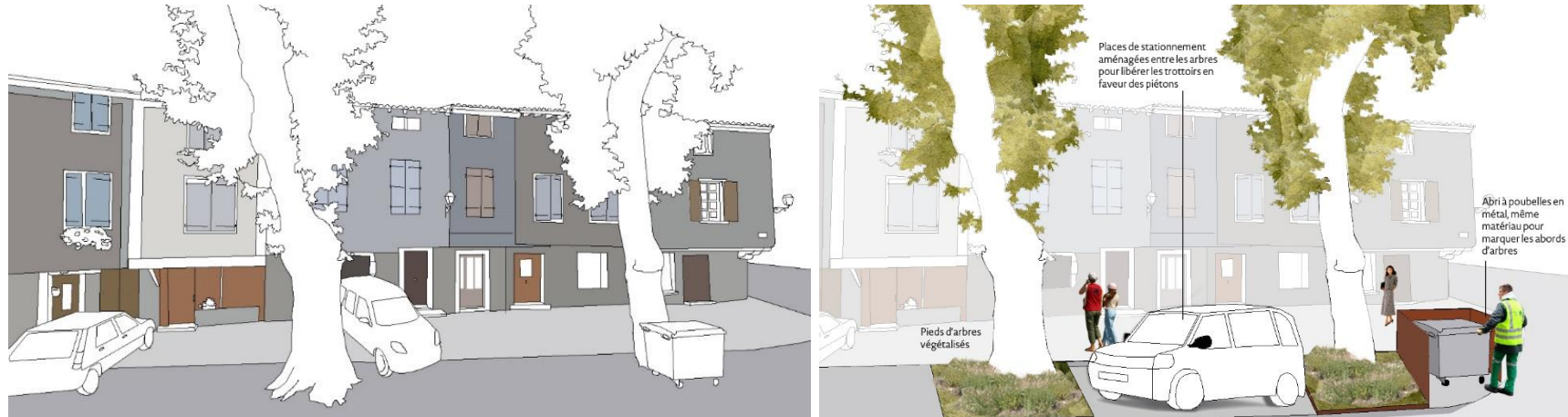
Croquis des maisons à colombages réhabilitées à Chalabre : certains enduits sont réalisés à la chaux, les éléments en pierre sont conservés ainsi que certains éléments en bois. Le nuancier pourrait être revisité avec des couleurs plus lumineuses. L'espace public est à requalifier (à gauche) / Principe proposé de requalification de l'espace public : libération du trottoir en faveur des piétons, relocalisation des poubelles, végétalisation, etc (à droite).
