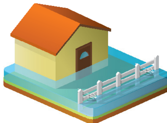
Figure n°3: Exemple de clôture assurant la transparence hydraulique. Source : Mayane pour la DDT du Bas-Rhin, 2017.
