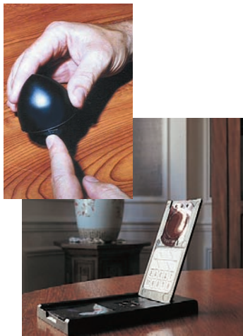
Exemples de dosimètres utilisés par l'IRSN pour les mesures dans les bâtiments.
