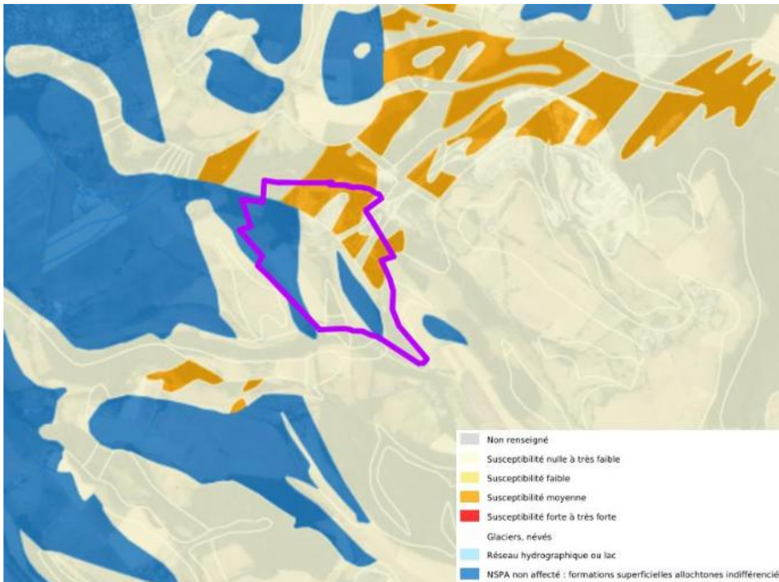
Susceptibilité de présence d'amiante (BE ARTIFEEX- en charge de l'élaboration de l'évaluation environnementale projet)
