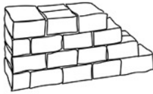
Appareillage réglé, à assises régulières.
