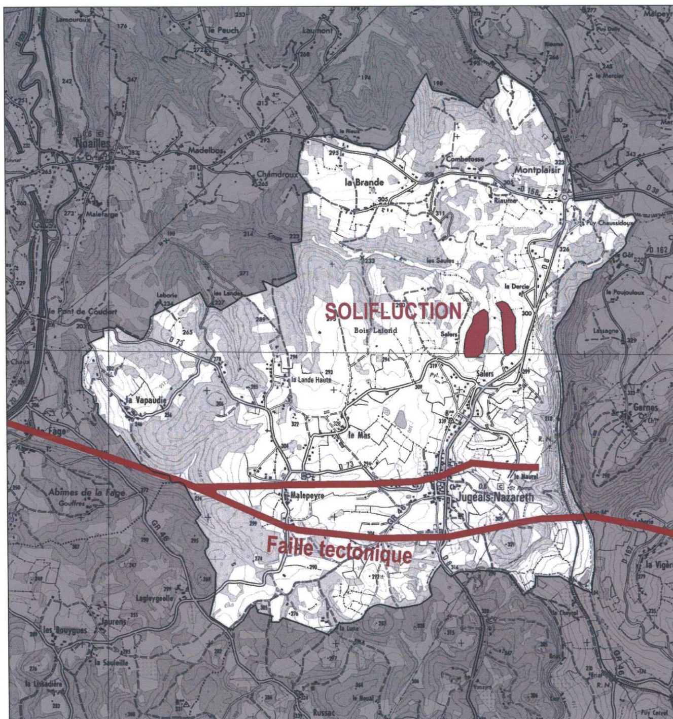
Figure 56 : Cartographie de la faille tectonique et des zones de solifluction (Source : Préfecture de la Corrèze – DDE)
