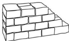
Appareillage réglé, à assises régulières.
