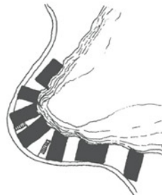
#hameau accroché à la falaise, implantation perpendiculaire à l'affleurement rocheux, lui même servant d'appui à la construction (possibilité d'habi- tat troglodytes)
