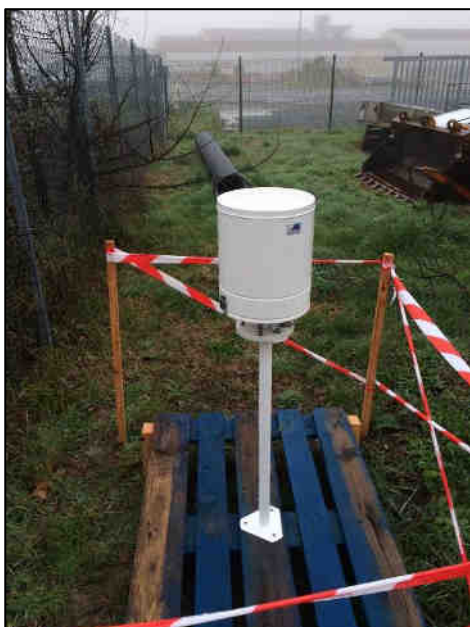
Figure 5 : prises de vue du pluviomètre et du débitmètre installés
