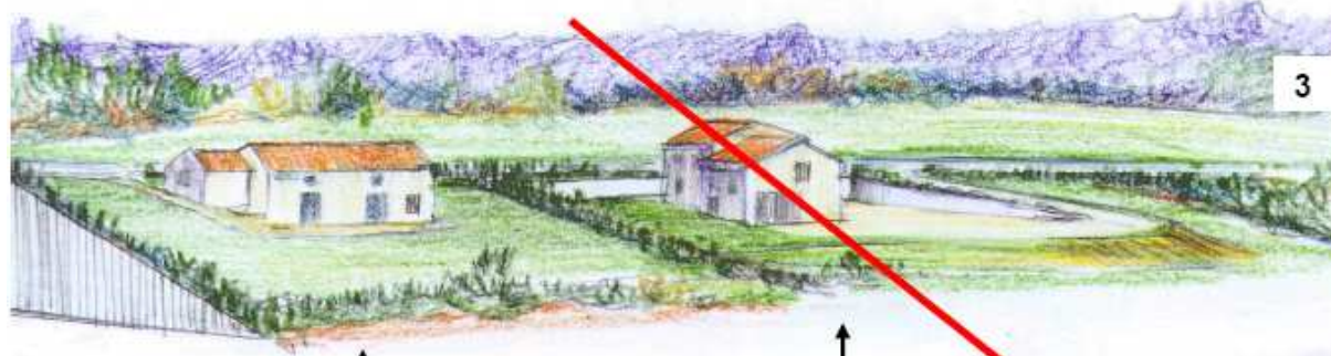
2 Remblais artificiels recouvrant partiellement le rez de chaussé.
