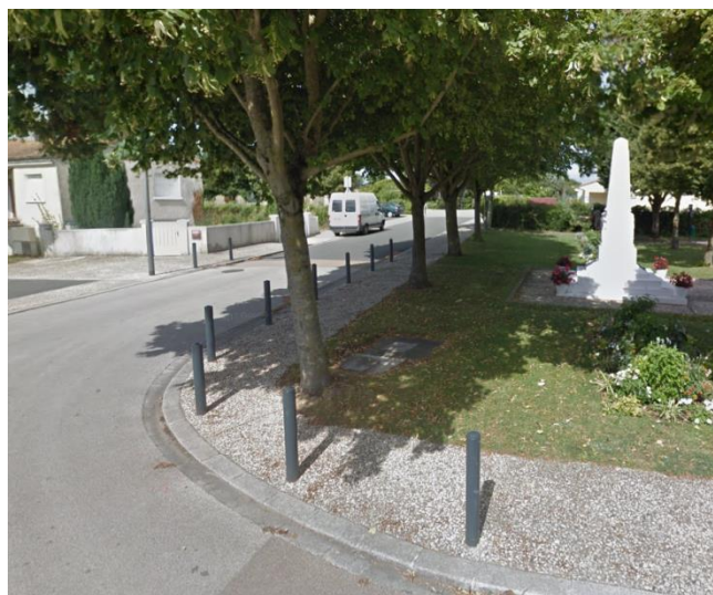
Chaussée avec potelets séparatifs, accotement piéton en béton désactivé et engazonnement arboré
