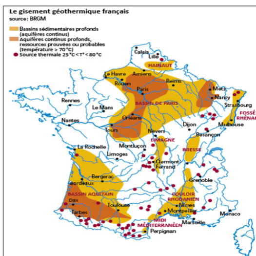
Gisement géothermique en France (Source : BRGM)
