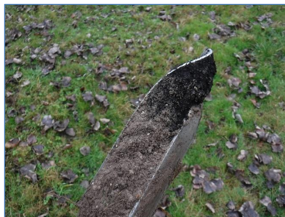
Sondage pédologique caractéristique de zone humide : sol rédoxique à gauche et sol tourbeux à droite
