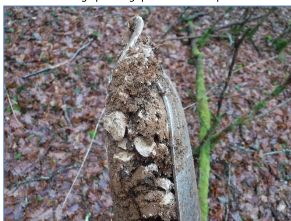
Sondage non caractéristique sur sols de groie (sols peu profonds) avec débris calcaires nombreux
