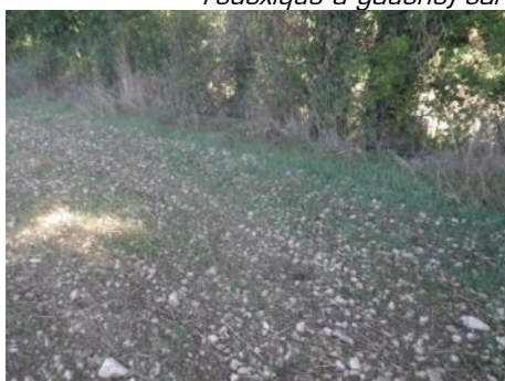
Sondage non caractéristique sur sols de groie (sols peu profonds) avec débris calcaires nombreux et apparition de la roche mère en fin de sondage (refus de tarière à droite)
