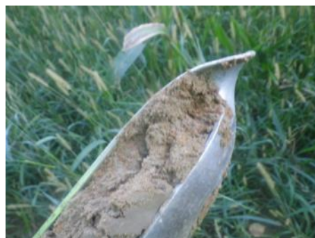
Sondages pédologiques caractéristiques de zone humide traduisant un engorgement temporaire (sol rédoxique à gauche) caractérisés par des dépôts de fer oxydé
