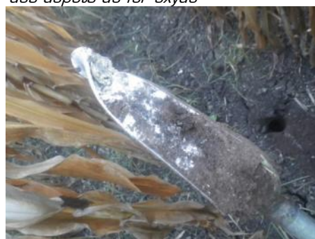
Sondage non caractéristique sur sols de groie (sols peu profonds) avec débris calcaires nombreux et apparition de la roche mère en fin de sondage (refus de tarière à droite)
