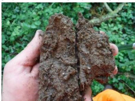
Sondages pédologiques caractéristiques de zone humide traduisant un engorgement temporaire (sol rédoxique à gauche) caractérisés par des dépôts de fer oxydé
