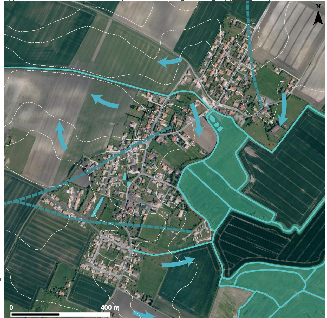
Approche sommaire des écoulements pluviaux sur le bourg de Beaugeay (source : IGN)
