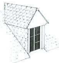
Lucarne à bâtière
