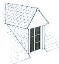
Lucarne à bâtière
