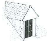
Lucarne à bâtière
