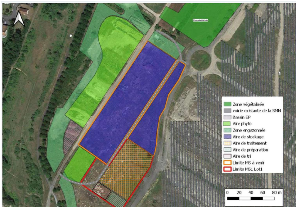
Figure 6 : Plateforme de recyclage des terres excavées (opération PRETEX) – (source : Normandie aménagement).
