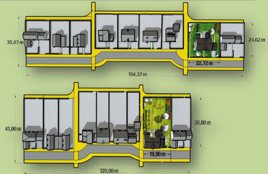
Illustration schématique d'une économie de voie par une réflexion sur la largeur de parcelle sans impacter le cadre de vie (CAUE 53).
