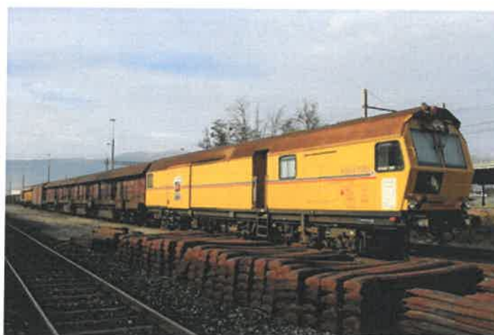
Train meuleur de rails (Scheuchzer S.A.)
