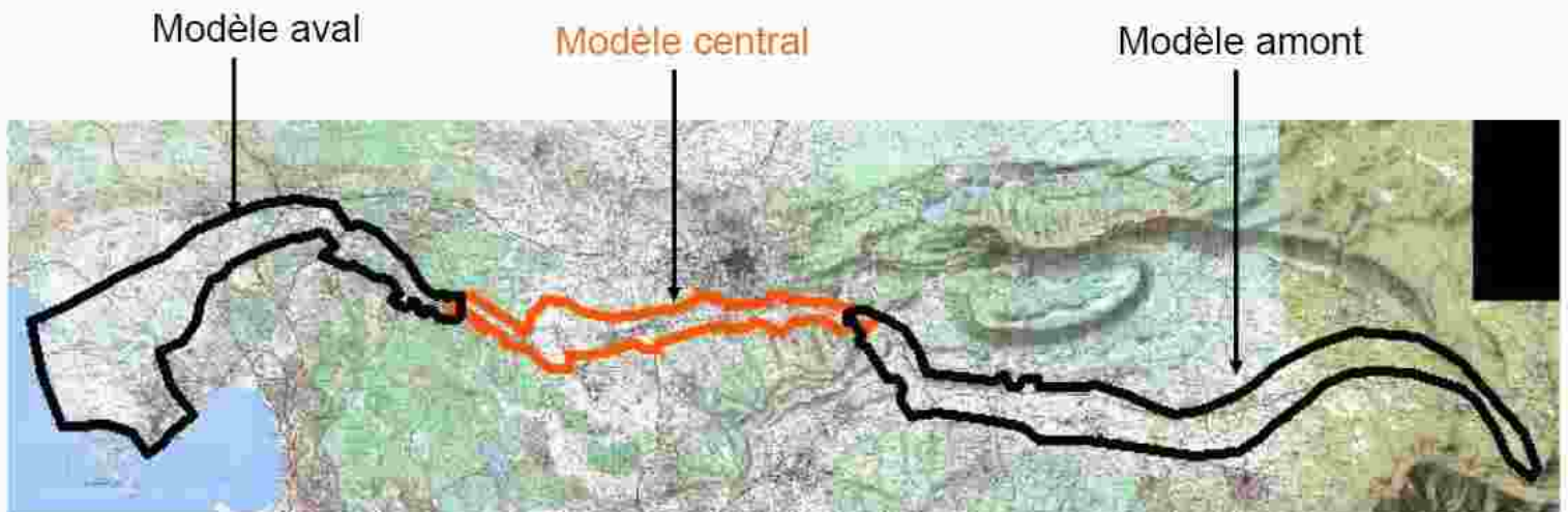
Figure 22 : Emprise des trois modèles hydrauliques
