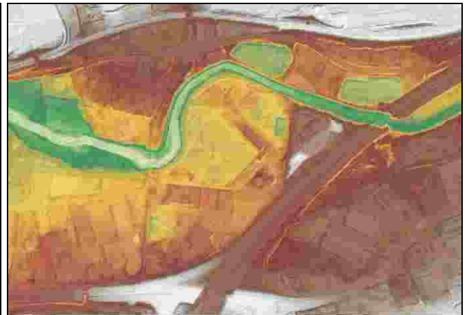
Vue lidar du MNT (modèle numérique de terrain) : 1 point tous les mètres –relevé par avion
