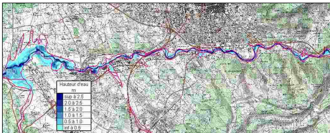
Figure 63 : Hauteurs d'eau issues du modèle hydraulique de la crue de 1978 et emprise historique de la crue sur le secteur Gorges de Langesse/Saint Pons
