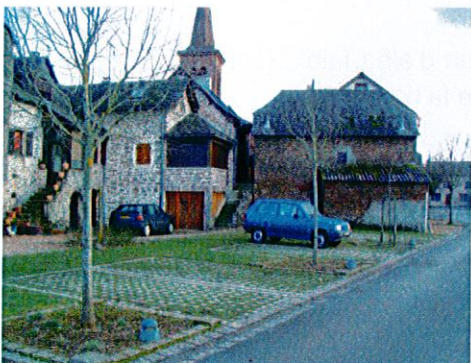
Les stationnements enherbés donnent l'assurance d'un revêtement stable, propre à supporter le poids des véhicules, sans altérer la perméabilité du sol.
