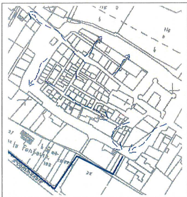
Les principales voies d'évacuation des eaux pluviales (traits discontinus) L'ancienne canalisation eaux usées, utilisée pour le pluvial (trait plein). (Source : Mairie)
