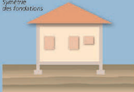
Dissymétrie des fondations
