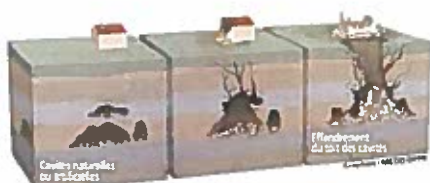
Effondrement de cavités souterraines
