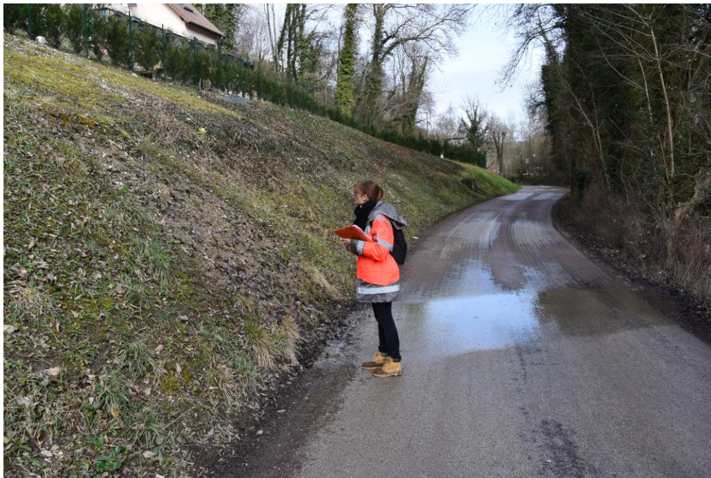
Illustration 15 – Résurgence en bas du versant sur la route et en aval des maisons (BRGM, 2015)
