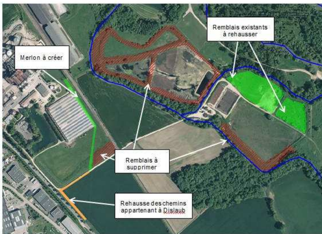
Figure 16 : Futurs aménagements de la société Dislaub, intégrés au PPRi
