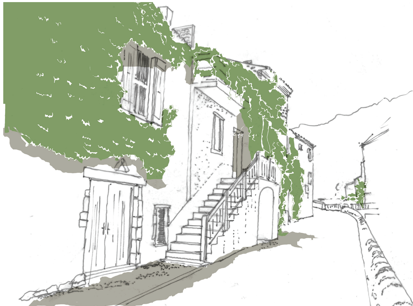
Saint-Montan - La vigne vierge est très fréquente sur les façades Sud des bâtiments. Les feuillages protègent les murs des rayons de soleil l'été, et en hiver, l'absence des feuilles laisse le mur au contraire absorber les calories du rayonnement. Elles assurent ainsi une certaine isolation, les pics de température sont atténués de 28 %.
