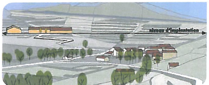
Bâtiment agricole implanté à proximité d'un village, trop visible sur la pente, avec un chemin d'accès complexe et trop large (effet cicatrice).
