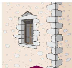
Enduit de rejointoiement (joints « beurrés ») avec encadrement de fenêtre et chaîne d'angle harpés en pierre apparente dégrossie
