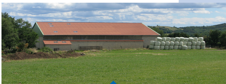
Cas des bâtiments agricoles : préférez des volumes compacts, des tuiles en couvertures et une végétation locale pour leur intégration dans le paysage. Ils ne devraient pas être implantés au dessus d'une ligne de crête.
