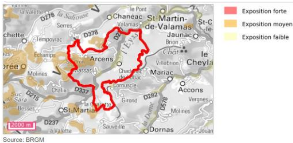
Retrait-gonflements des sols argileux d'Arcens, source : Géorisques
