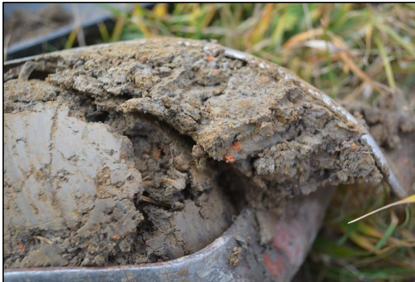
Trace marquées d'oxydation (tâches rouille) et de réduction (couleur gris/bleu) après 40cm de profondeur
