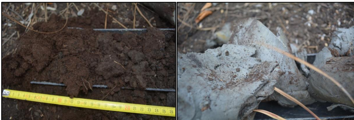
Horizon de 0 à 20cm (horizon organique) et horizon réduit (« gley »)
