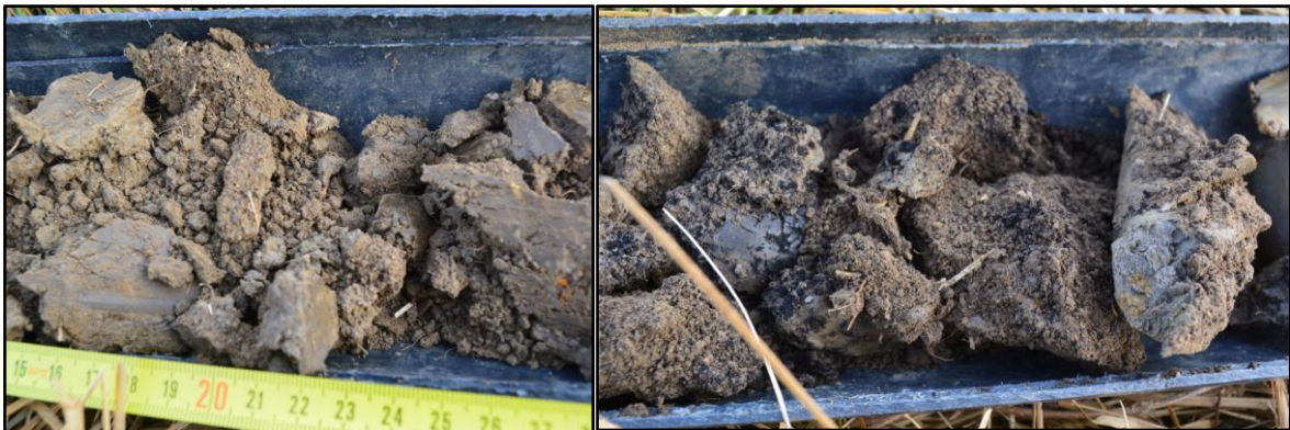
Horizon rédoxique (photo de gauche) et horizon réductique (photo de droite)
