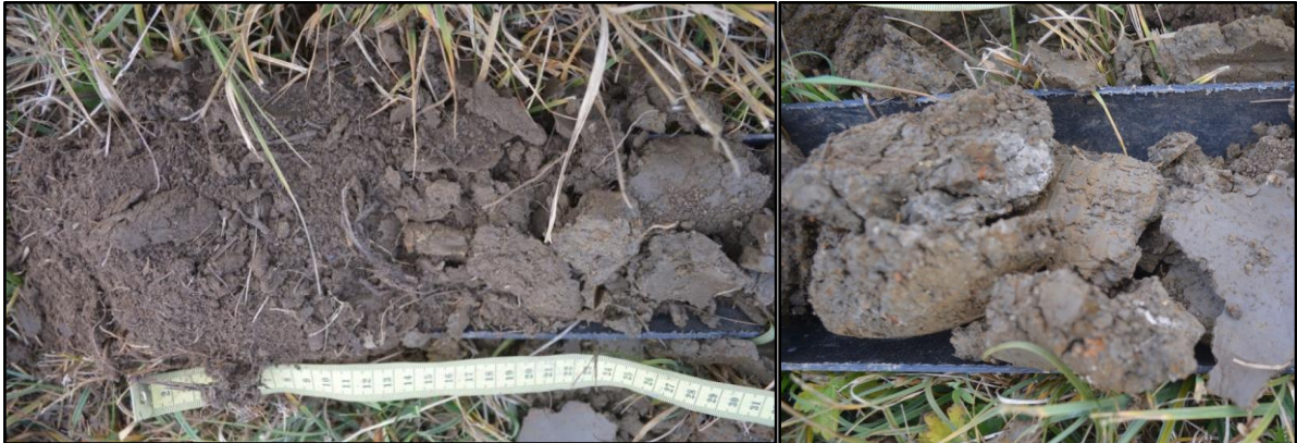
Horizons de 0 à 20 cm (photo de gauche) et zoom sur les traces marquées d'oxydation à 30 cm
