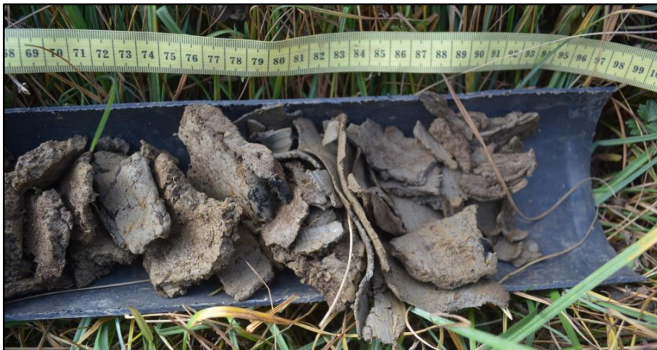
Horizon à 90cm avec une structure lamellaire et la présence de trace d'hydromorphie du sol
