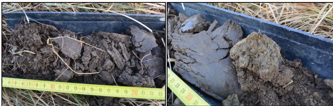
Horizon 0 à 20cm (photo de gauche) et traits d'hydromorphie à 30cm (photo de droite)
