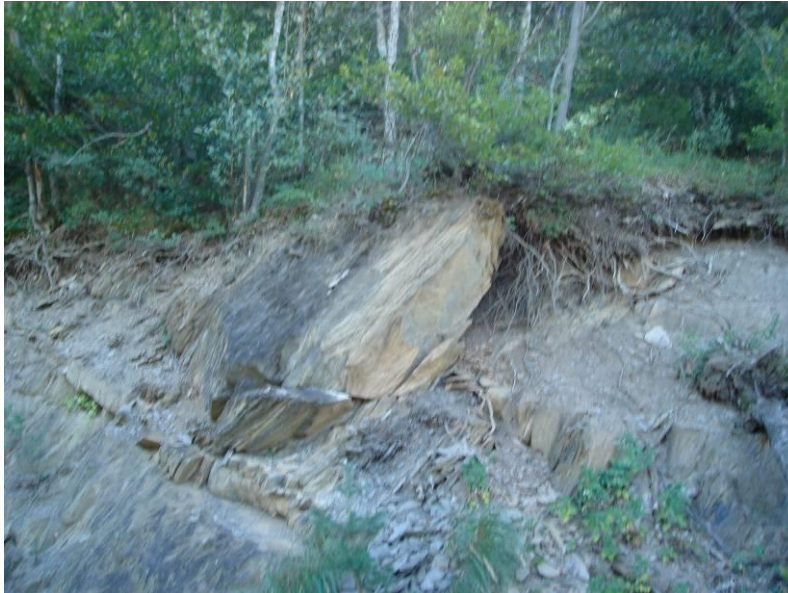
Affleurement rocheux (calcaire argileux et calschistes) dans le talus sur le chemin de la Broue.
