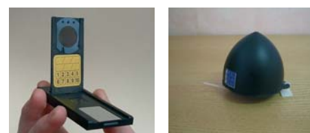
Dosimètre utilisé pour les mesures dans les habitations
