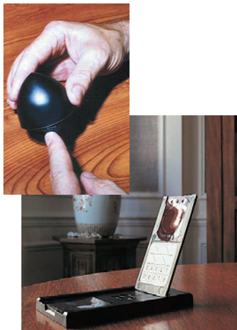
Exemples de dosimètres utilisés par l'IRSN pour les mesures dans les bâtiments.
