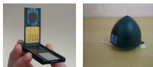
Dosimètre utilisé pour les mesures dans les habitations
