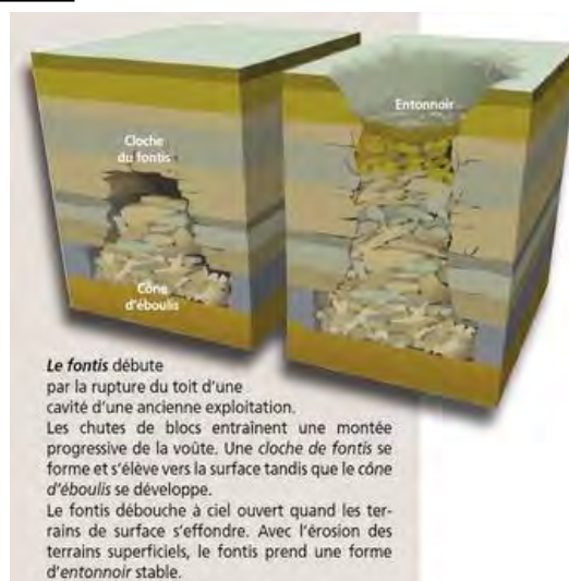
Illustration du phénomène d'effondrement localisé
