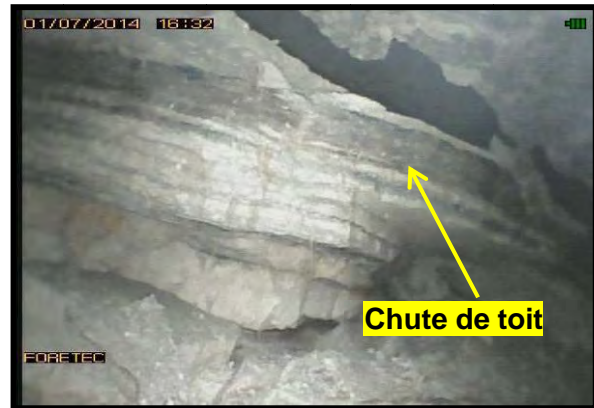
Figure 9 : Exemples de chutes de toit observées au droit du secteur Centre Sigonce
