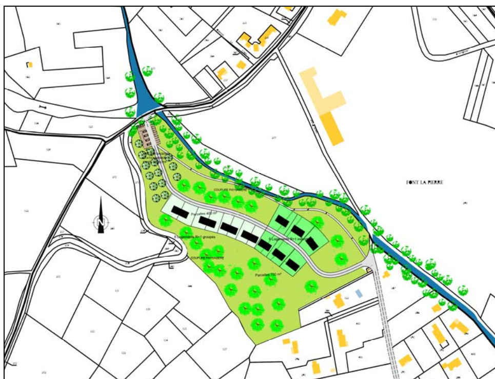
Scénario intéressant car respectueux des courbes de niveau avec une partie haute (la plus visible) et des abords de ripisylve préservés mais cela nécessitait d'urbaniser sur la parcelle communale vouée à des équipements collectifs
