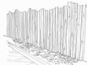
Clôture en palissade de bois rythmée par des planches de hauteur variable
