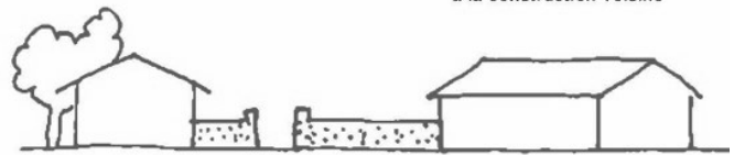
liaison par un mur à la construction voisine
