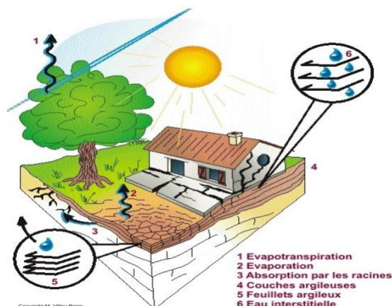
fig. 1 : illustration du mécanisme de dessiccation
