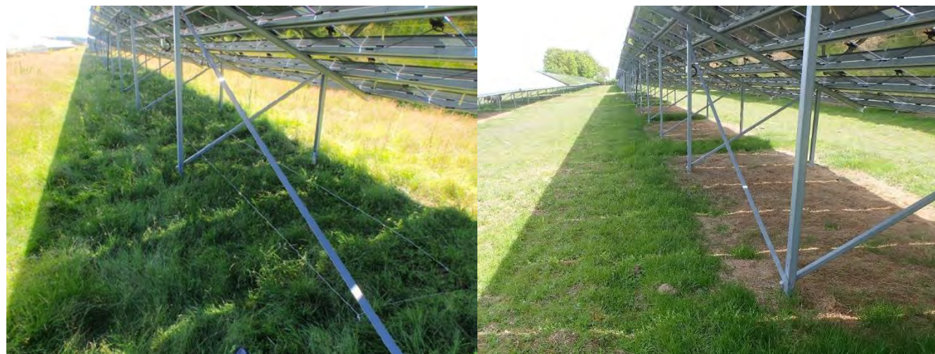
Effet possible de la réduction de la pluviométrie sous les panneaux sur la végétation selon les conditions et la gestion (contexte favorable à gauche et défavorable à droite)
