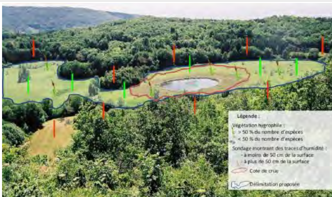
Illustration 96 : Exemple de délimitation d'une zone humide
