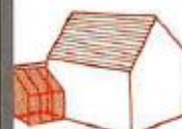
Véranda d'angle avec toiture en appentis
