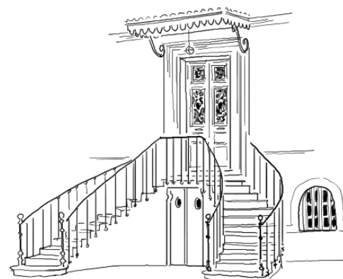
Garde-corps* de perron* et marquise* en fer forgé
