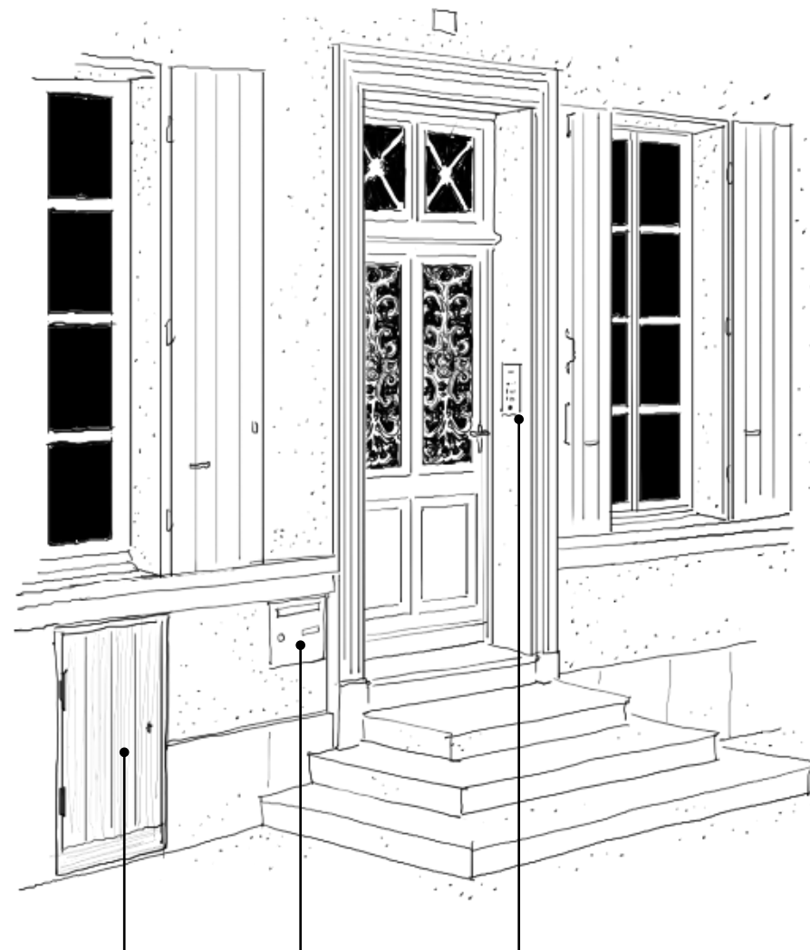
Coffrets techniques dissimulés par un volet en bois
