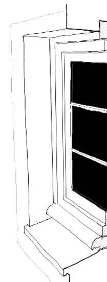
Pose en rénovation, dépose partielle
