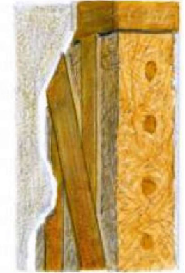
Mur en pan de bois et torchis enduit à la chaux.
