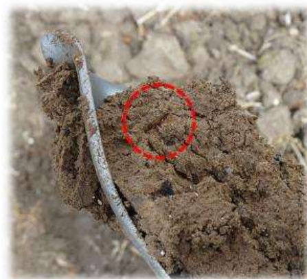
Figure 11 : Sondage n°2 – traces d'oxydation aux environs de 55 cm de profondeur (recouvrement >5%)
