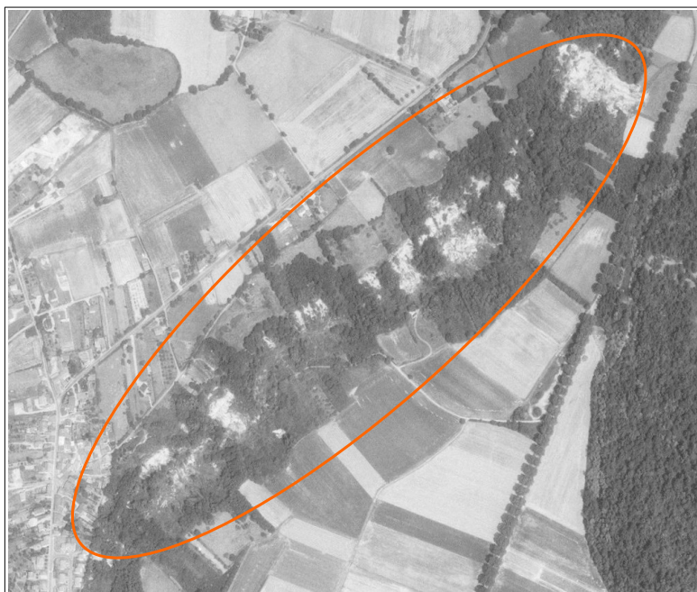
Figure III.78: traces de glissements de terrain sur le versant de Loyes visibles sur des photos aériennes de 1982.
