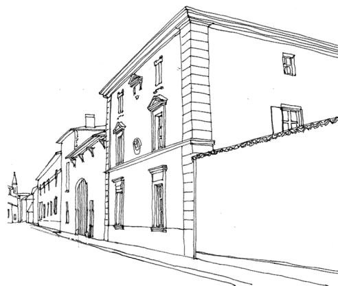
Ordonnement des ouvertures, effets d'ornementations : chaînes d'angles, corniches, frontons classiques.
