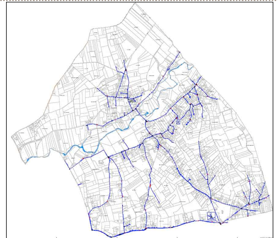
Réseau d'eau potable sur Saint-Didier-de-Formans
